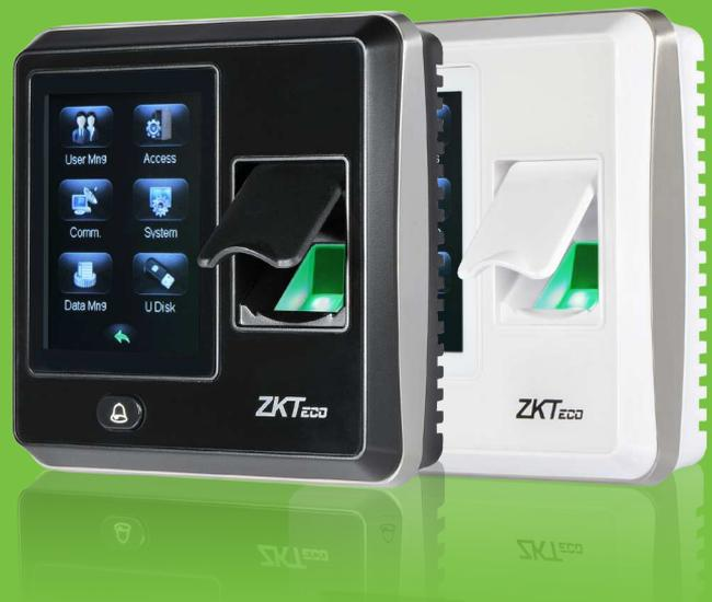
SF300 - это IP-терминал для снятия отпечатков пальцев, который работает в обоих сетевых режимах и автономный режим. Он может подключаться к программному обеспечению ZKAccess3.5 для контроля доступа и управление посещаемостью.
