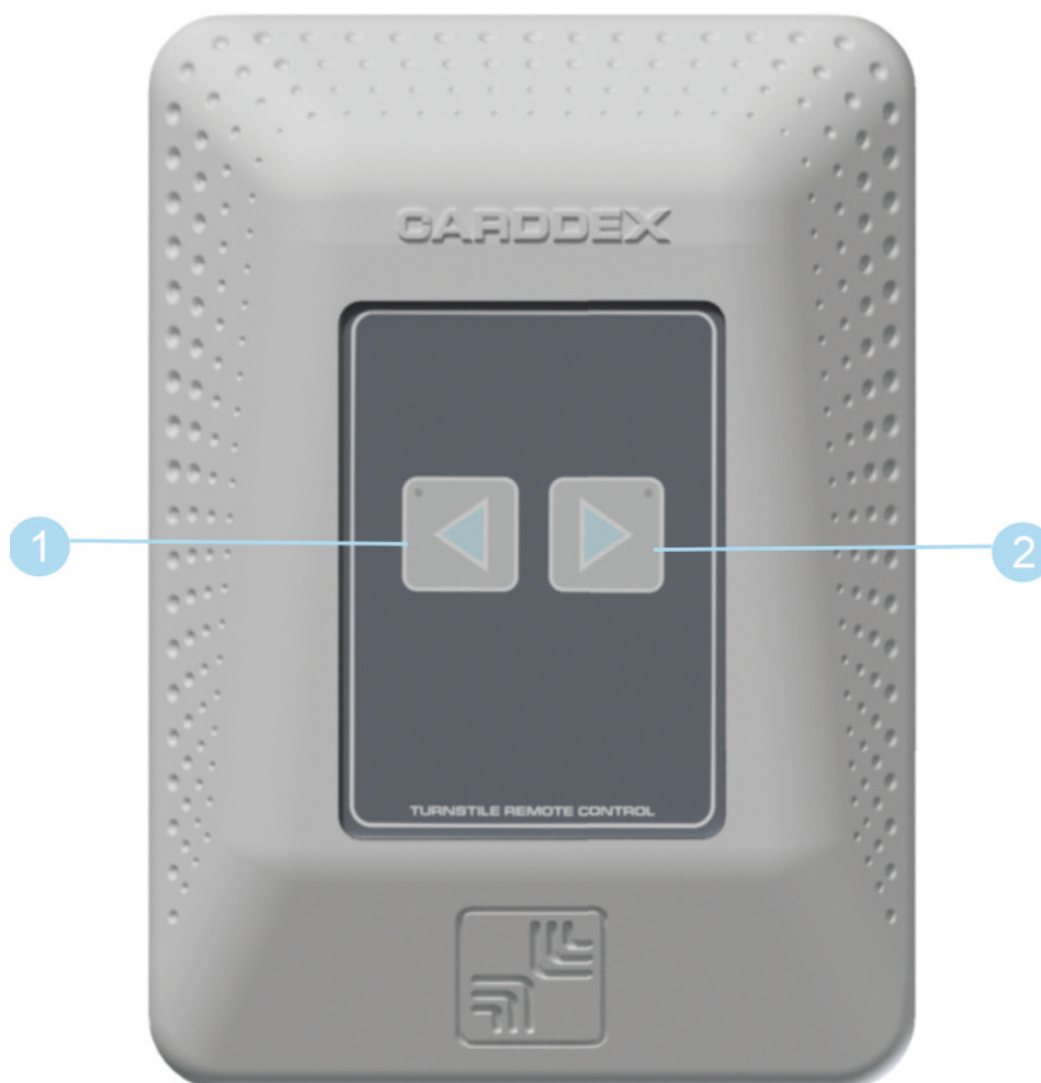
Рисунок 6.6.1 - Внешний вид ПДУ «TW-02»
