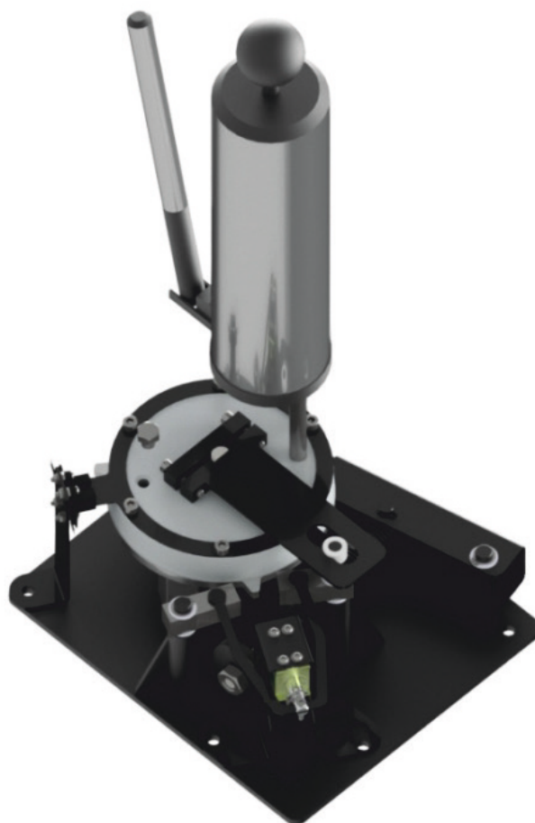
Рисунок 12.3.3 – Доливка демпферной жидкости
