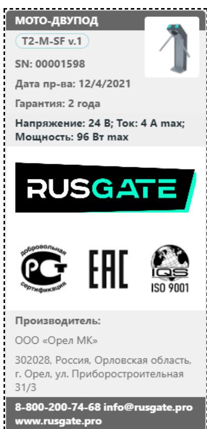
Турникеты имеют физическую маркировку в виде ламинированных этикеток, расположенных внутри корпуса турникета под Передним кожухом. Чтобы считать информацию с этикетки необходимо демонтировать Передний кожух, предварительно отсоединив преграждающие планки. Этикетка имеет вид, приведенный на рисунке.
