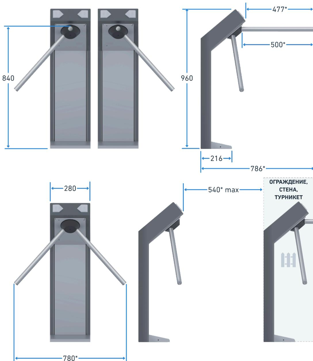
\* По индивидуальному согласованию с производителем, турникет может быть укомплектован специально изготовленными преграждающими планками рабочей длиной более 500 мм до 600 мм.
