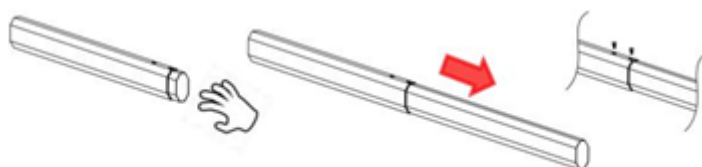
Рис. 1 Соедините главную стрелу со вспомогательной стрелой 2 винтами
