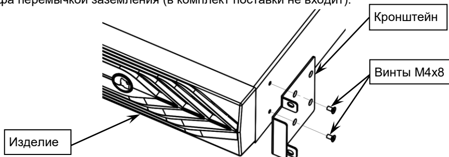
Рисунок 4 — Установка кронштейнов на корпус изделия.
