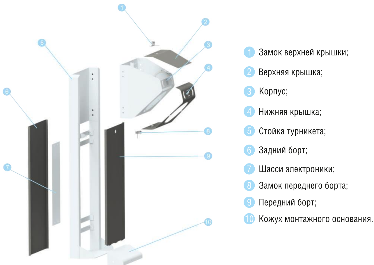
Рисунок 6.1.1 Устройство корпуса турникета
