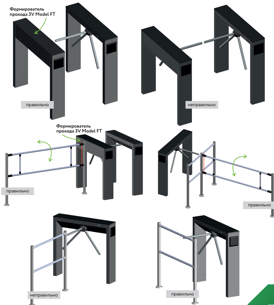
Рисунок 9.15 - Пример правильного и неправильного монтажа турникета
