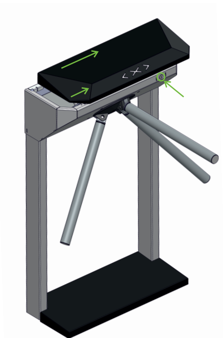
Рисунок 9.5 - Открытие крышки корпуса на примере 3V Model R(а)
