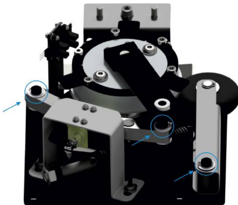
Рисунок 12.5.1 – Места смазки подвижных частей
