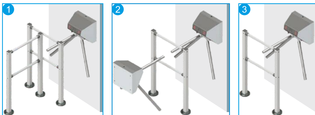
1 2 3 -турникет установлен правильно
