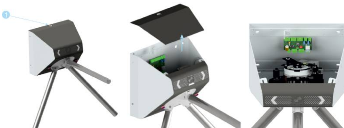
Рисунок 12.1.1. Демонтаж верхней крышки турникета
