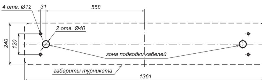
Разметка отверстий в полу под крепление турникета и зоны для подводки кабелей
