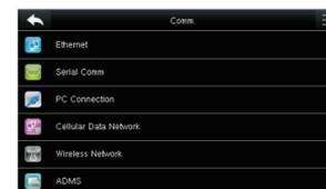
Ethernet: устройство может связываться с ПК через Ethernet. Serial Comm: устройство может связываться с ПК через последовательный порт. Подключение к ПК: установите пароль и идентификатор устройства, чтобы вы могли подключить устройство к программному обеспечению на ПК. Настройка облачного сервера: настройки, для подключения к серверу ADMS.
